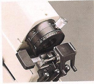
Şekil (.13) Ek kompensatörle 1 er \Delta diyoptrilik Aralıklarla 14 \Delta bazı fokometre modellerinde 22 \Delta ya kadar ölçüm vardır.
